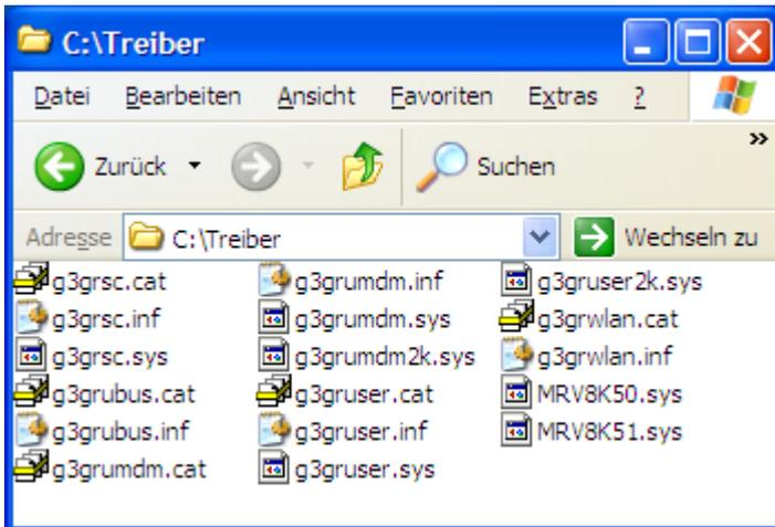
Schließen Sie jetzt das Funk-Modem an den PC an. Nach wenigen Sekunden öffnet sich ein Dialog, der Sie zur Installation von Software für die neu erkannte Hardware auffordert, es startet der **Assistent für das Suchen neuer Hardware**. Klicken Sie auf **Nein, diesmal nicht** und anschließend auf **Weiter**.
